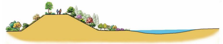
图图 7.3-9 文峪河堤防断面示意图
