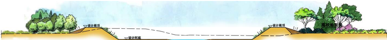
图 7.4-5 禹门河乡村段标准横断面图
