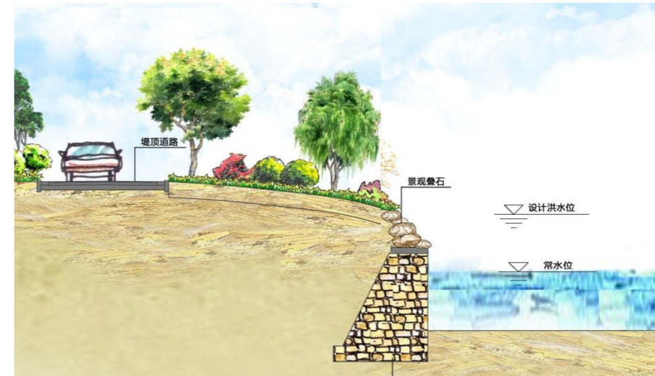
图 7.3-7 硬质堤岸改造
