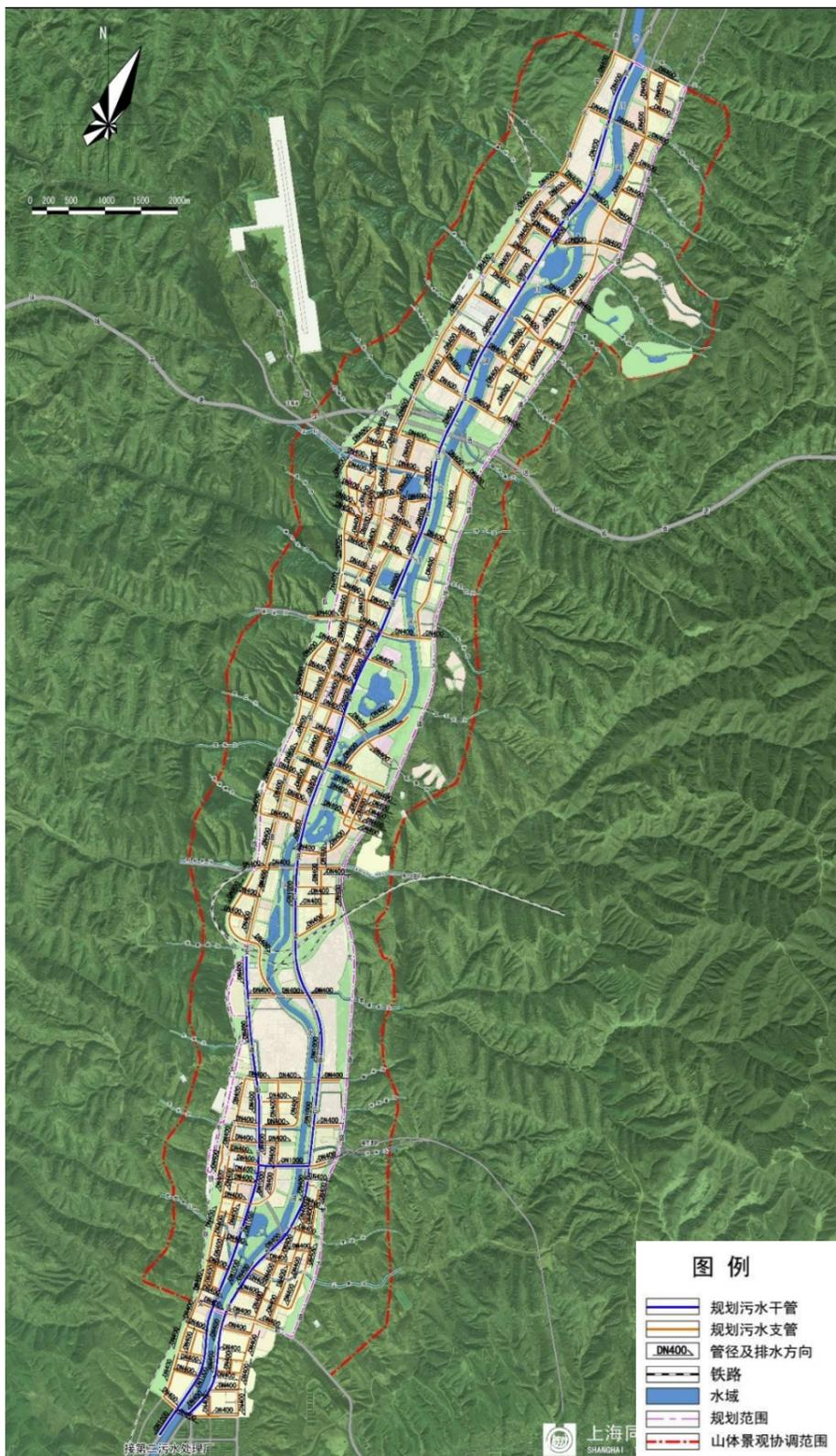
图 15-2 污水工程规划图
