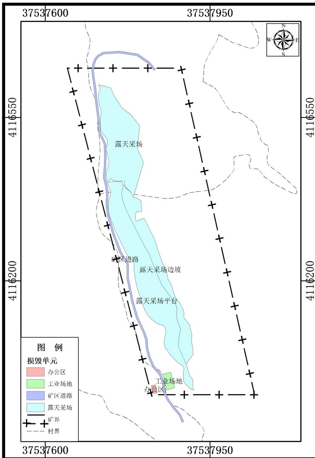
图 8-2-4 已损毁单元平面分布图
