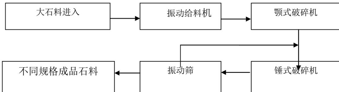
图 1-1-1 生产线流程图
