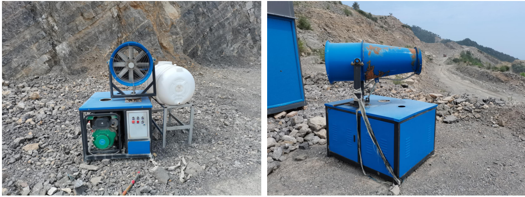
照片 5-2-7 除尘设备（雾炮）
