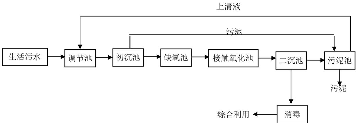
图 11-5-2 生活污水处理工艺流程图
