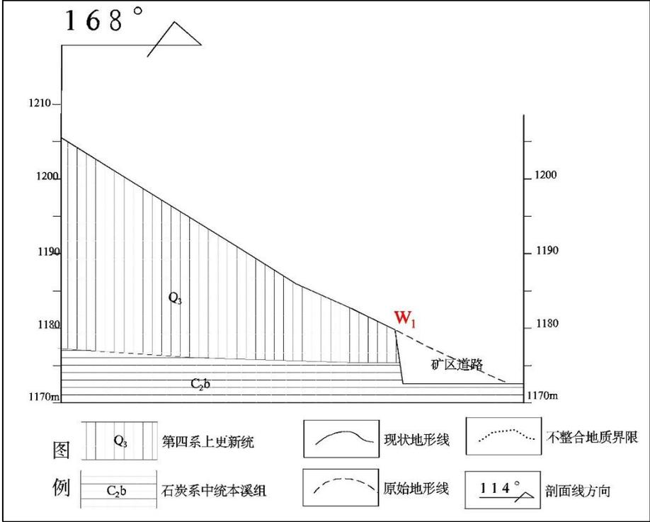
图8-3-1-1 W<sub>1</sub>不稳定边坡剖面示意图
