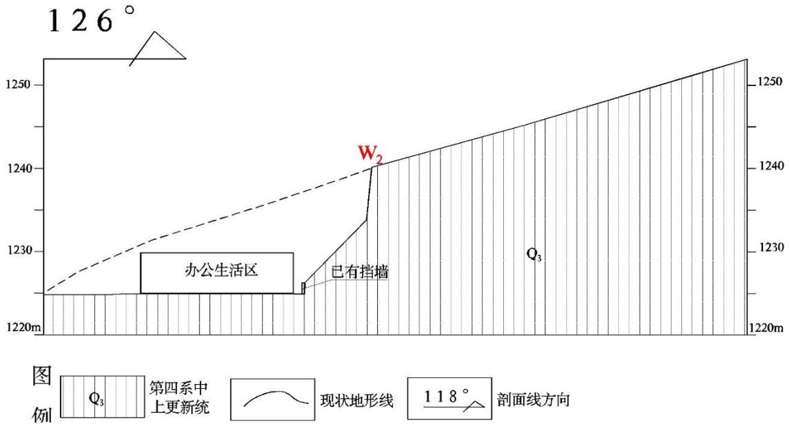
图 8-3-1-2 W<sub>2</sub> 不稳定边坡剖面示意图
