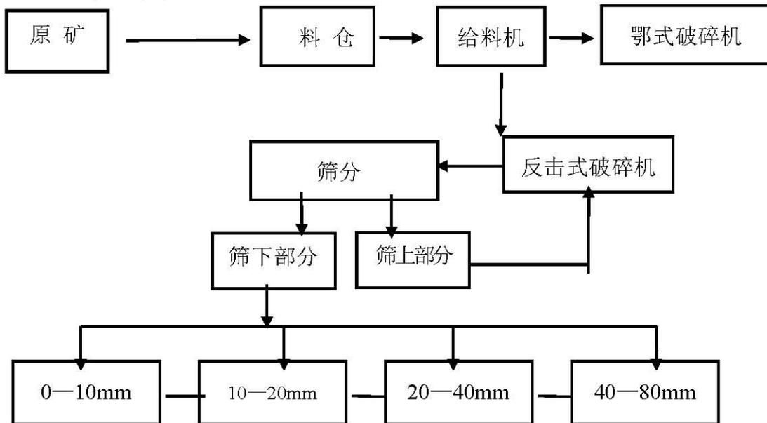
合格块度石料经格筛入料仓由给料机均匀地送进颚式破碎机进行粗碎，不合格大块在格筛上方，由碎石机破碎成合格块度后，通过料仓破碎系统；粗碎后的石料由胶带输送机送到反击式破碎机进行进一步破碎；细碎后的石料由胶带输送机送进格筛进行筛分，筛分出几种不同规格的石子，满足粒度要求的石子由成品胶带输送机送往成品料堆；不满足粒度要求的石子由胶带输送机返料送到反击式破碎机进行再次破碎，形成闭路多次循环。成品粒度可按照用户的需求进行组合和分级，为保护环境，可配备辅助的除尘设备。石料生产线的生产流程大致为：
