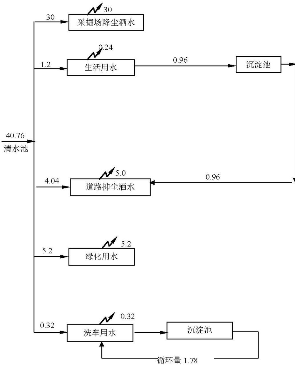
图 2-1-4 本项目水平衡示意图 m³/d
