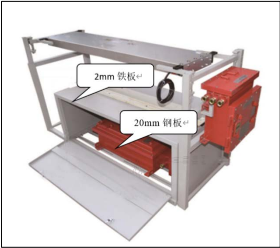
图 10-1 射线装置自带屏蔽措施示意图
