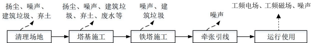
图 1 线路施工工艺图
