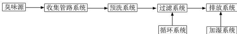
图 6.2-2 生物滤池除臭流程图
