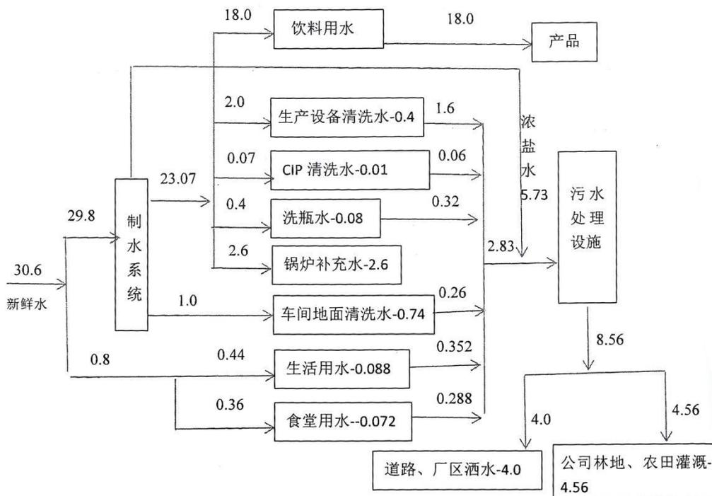
图 3-2 饮料生产项目采暖期水平衡图 (单位: m³/d)
