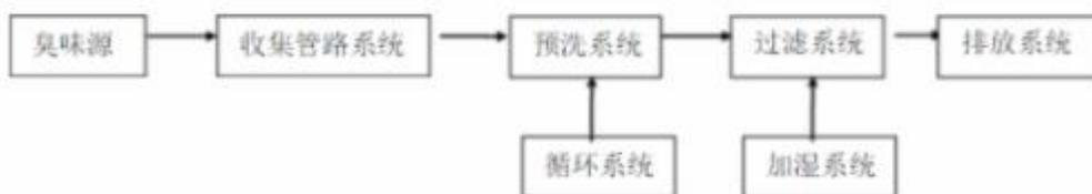
图 6.2-4 生物滤池除臭流程图
