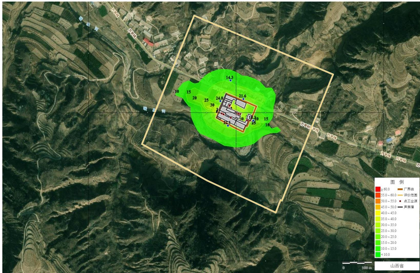
图 5.2-7 正常工况声环境影响预测结果图 注：等声级线图
