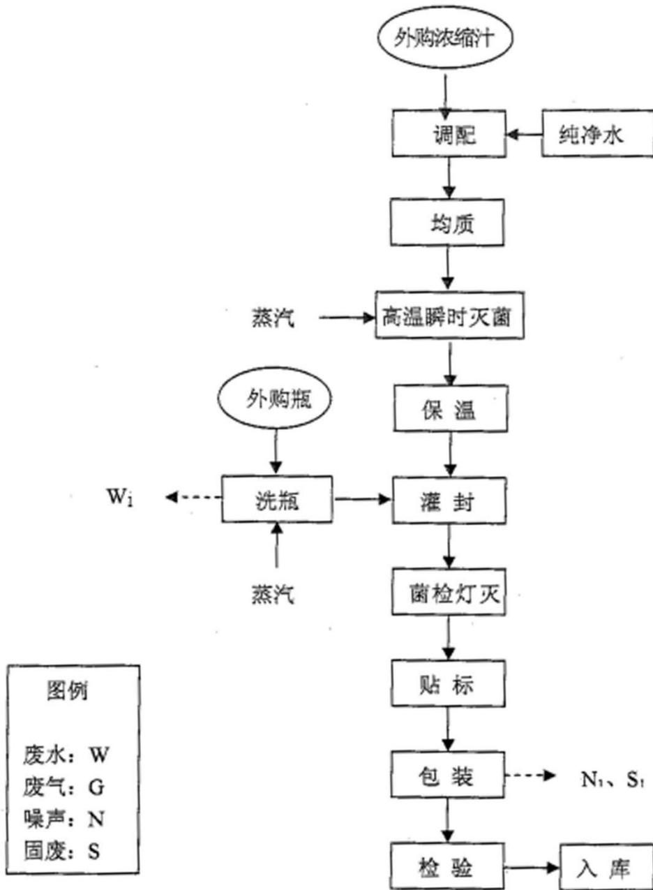
图 3-3 饮料生产工艺流程及污染物产出示意图
