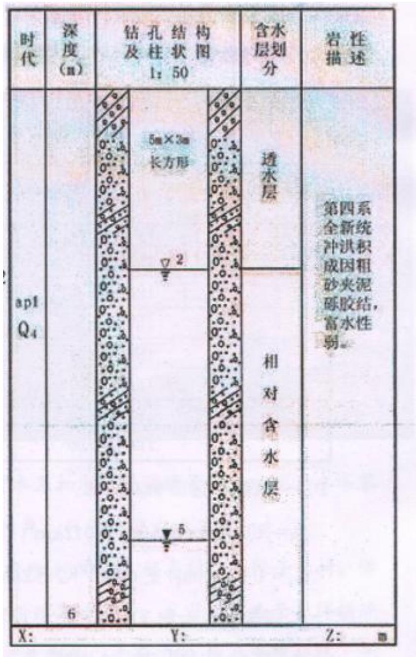
图 5.2-5 暖泉镇 2#集中供水井钻孔柱状图
