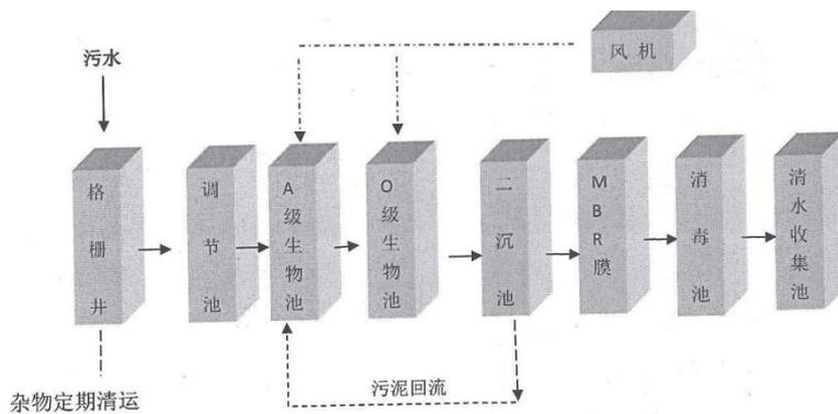
污水处理设施处理工艺流程图
