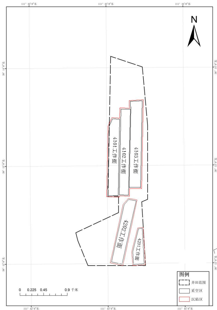
图 3-1-5 4号煤层采空区分布图
