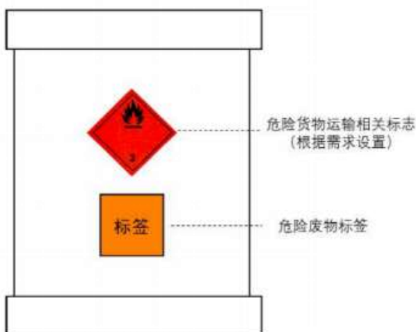
图 6.2-3 危险废物标签设置示意图
