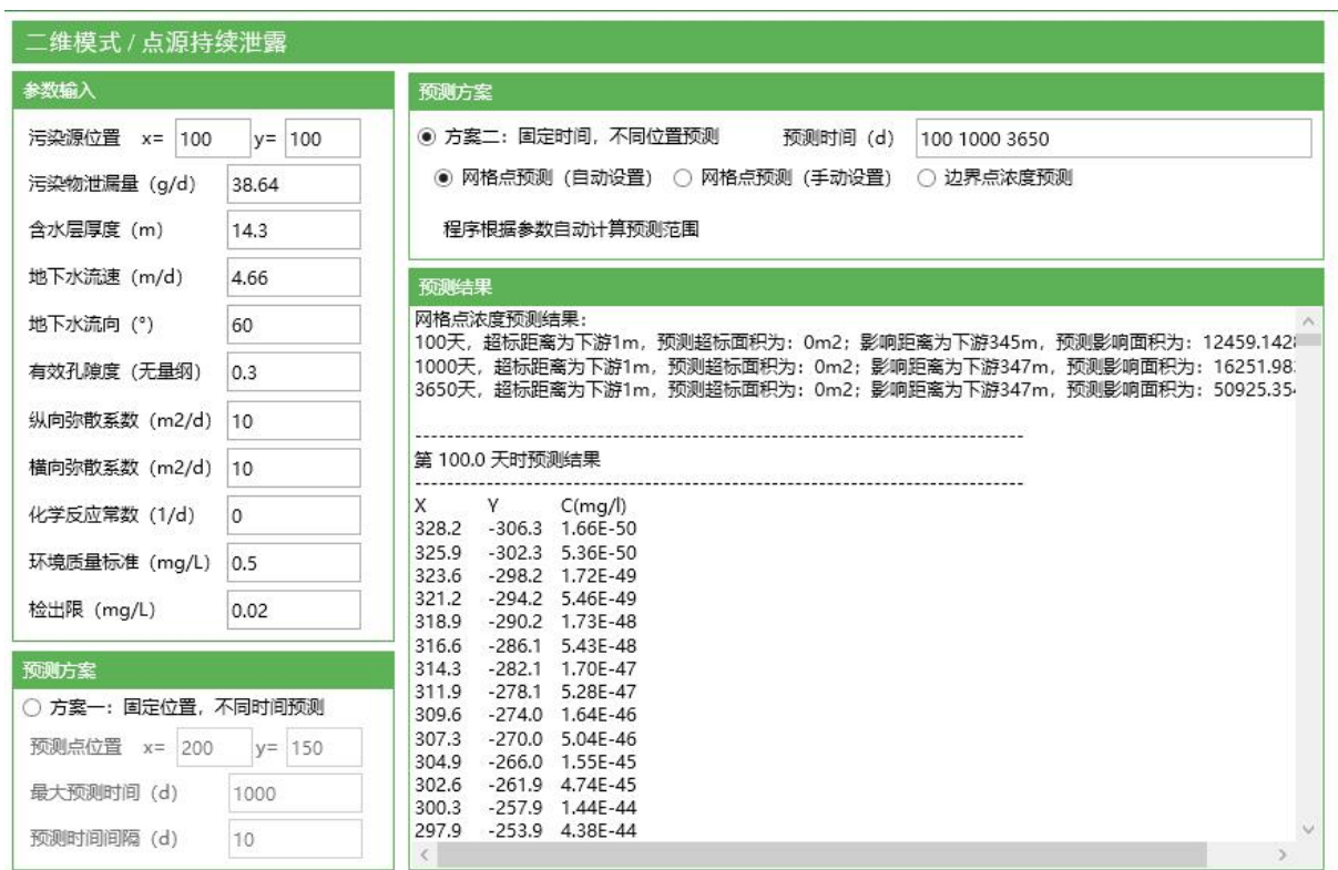
图 5.2-5 泄漏后氨氮预测结果
