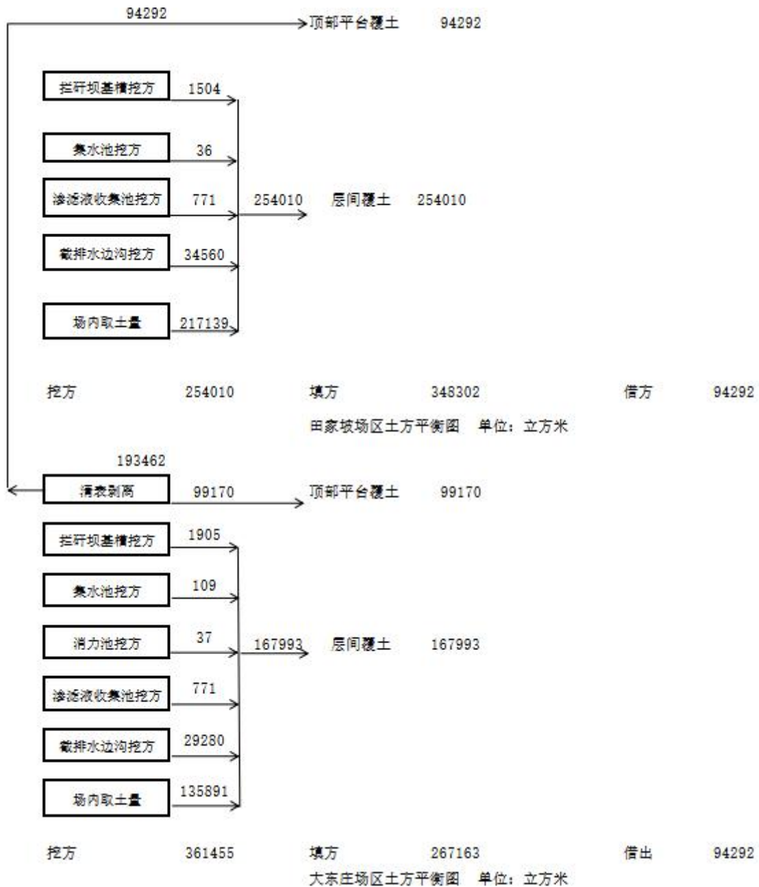
图 3.4-2 土方平衡图
