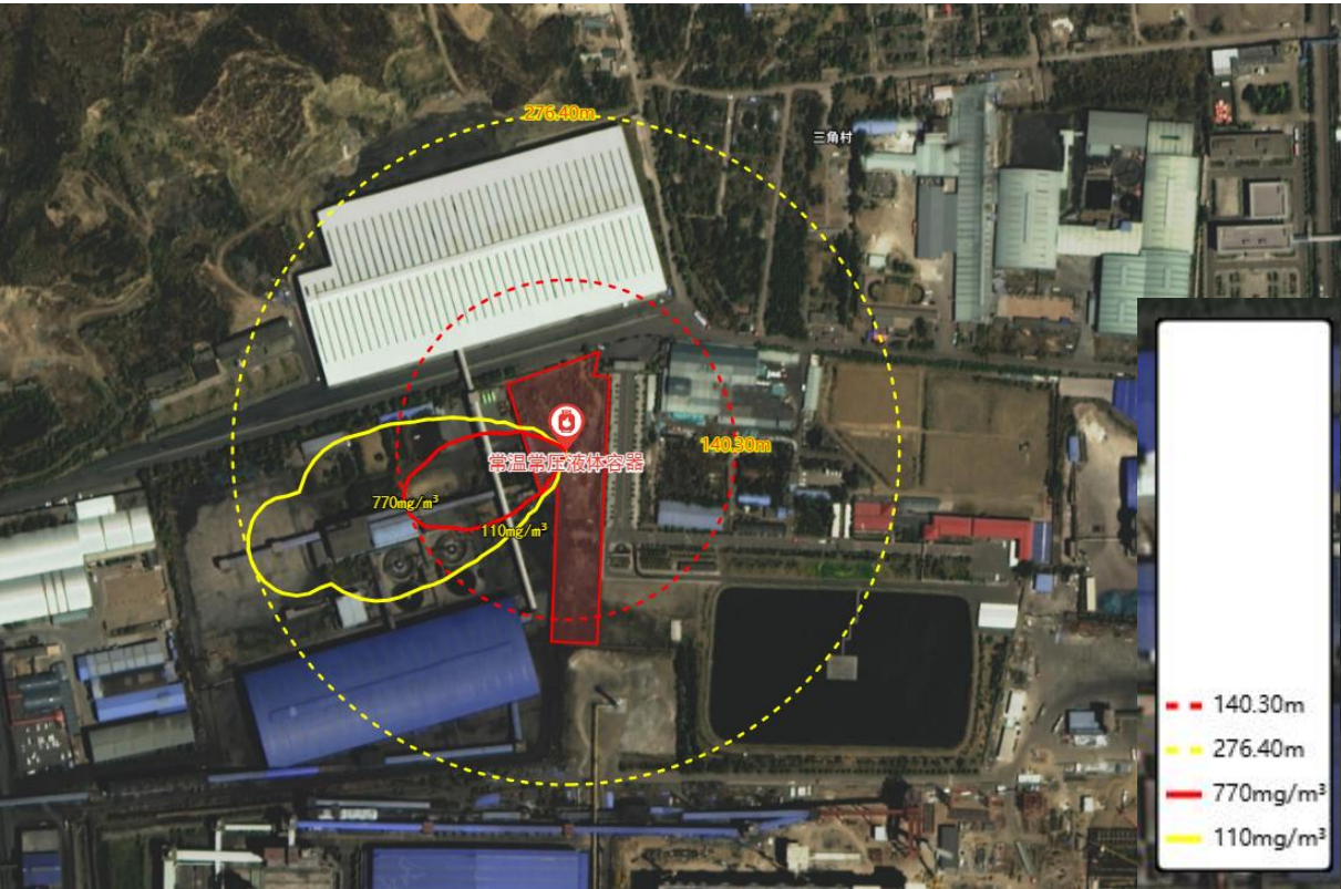
图5.2-36 最常见气象条件下原料储罐泄漏事故源项及事故后果图
