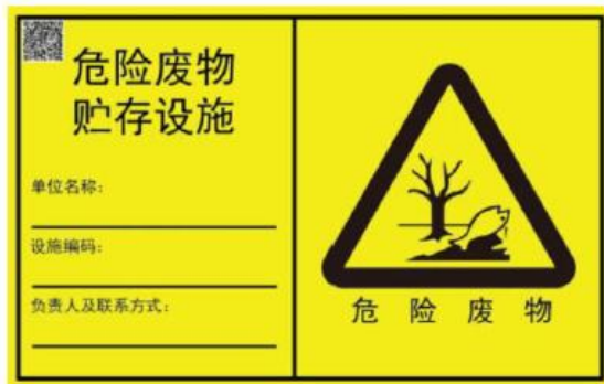
危险废物贮存设施标志
